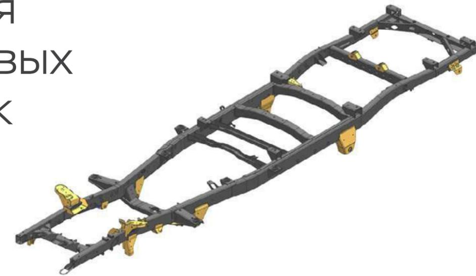
Благодаря прочной рамной конструкции УАЗ Профи прекрасно адаптирован под российские условия эксплуатации и предусматривает возможность установки широкой гаммы надстроек. Модель оснащается колесными дисками с шестью точками крепления и специальными усиленными шинами для коммерческого транспорта. Каждая покрывка выдерживает самые высокие нагрузки благодаря увеличенному профилю и повышенной норме слоистости для грузовых автомобилей.
